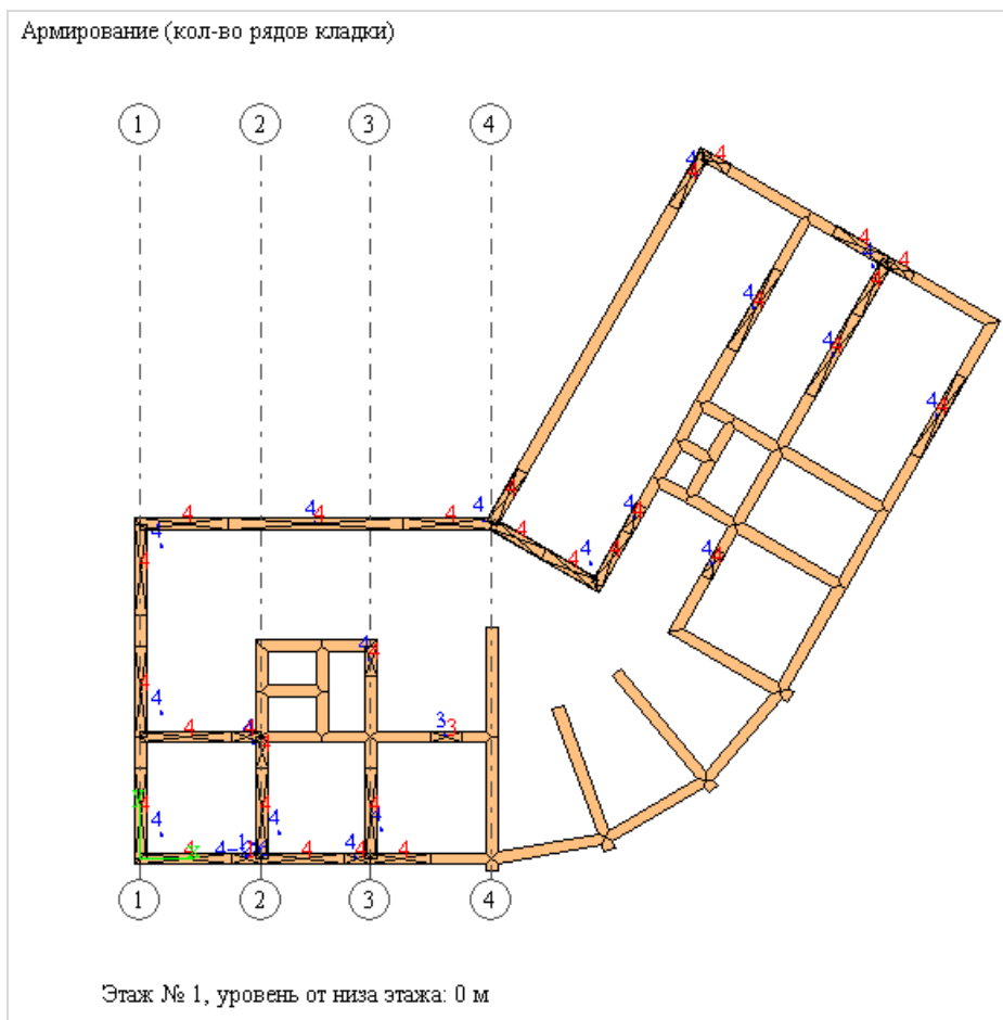
Рис. 10.6.6. Раскладка сеток армирования, этаж №1, отметка +0.000
