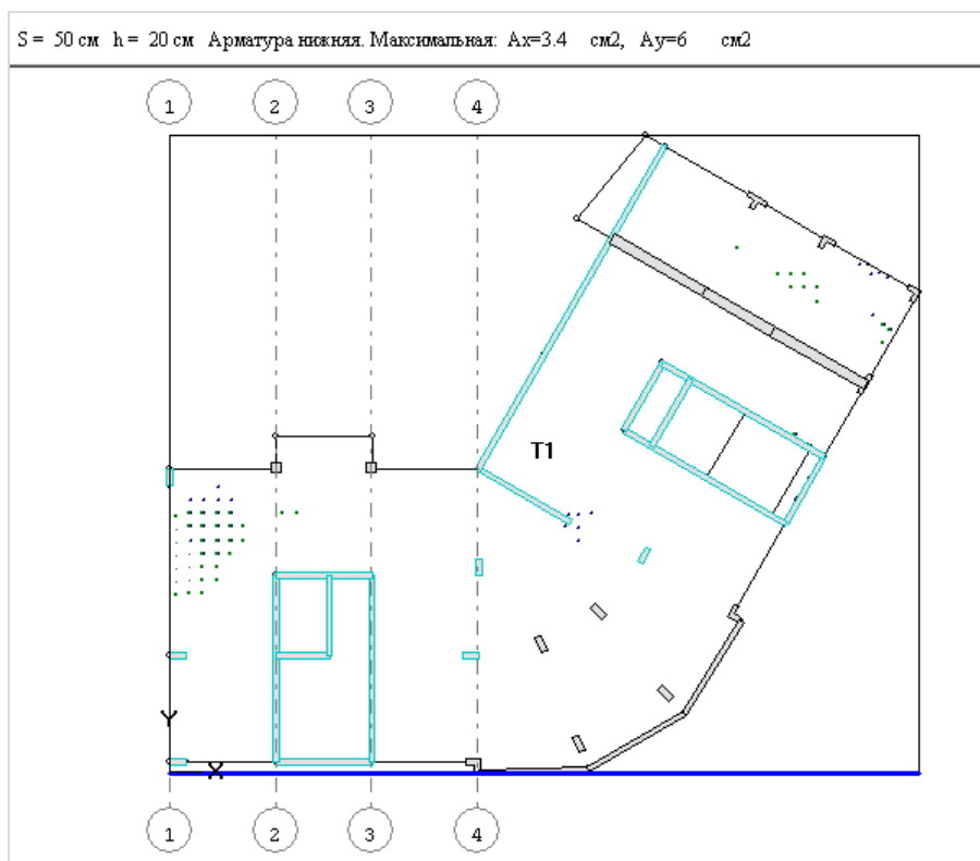
Рис.2.7.6. Остаточное армирование у нижней грани плиты
