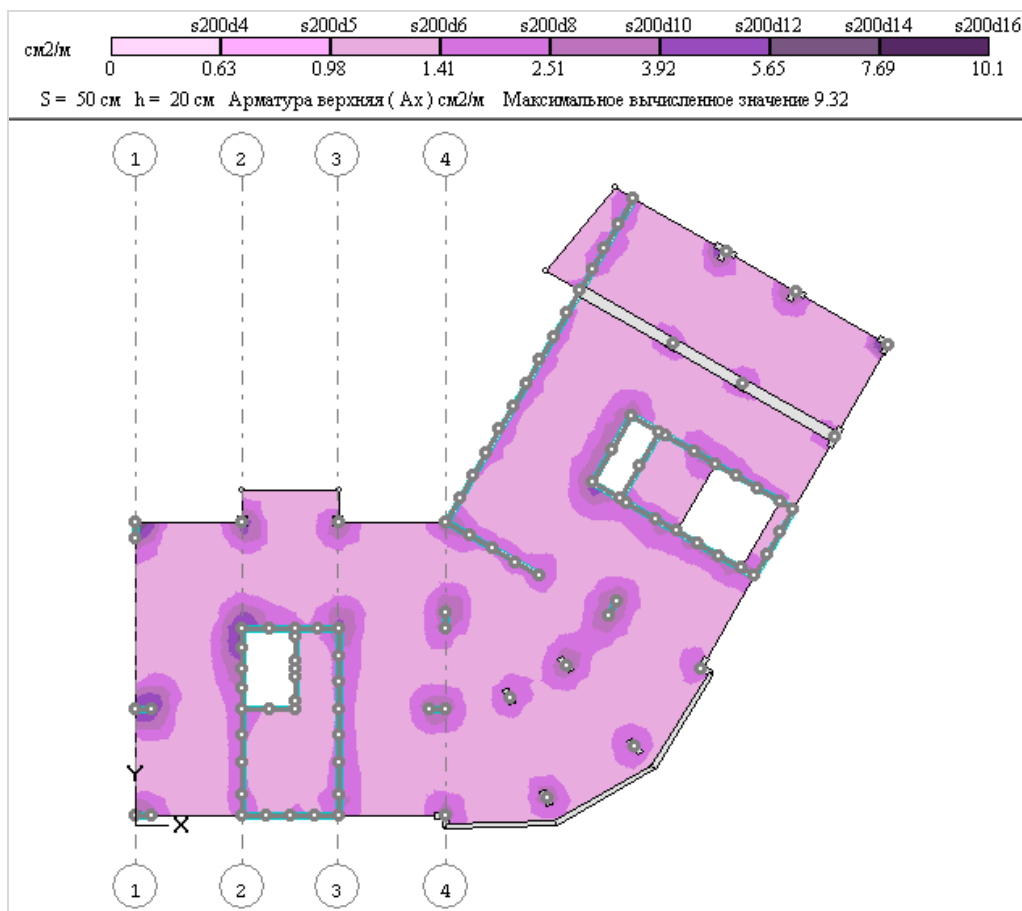
Рис.2.4.8. Изополя армирования Ax у верхней грани плиты
