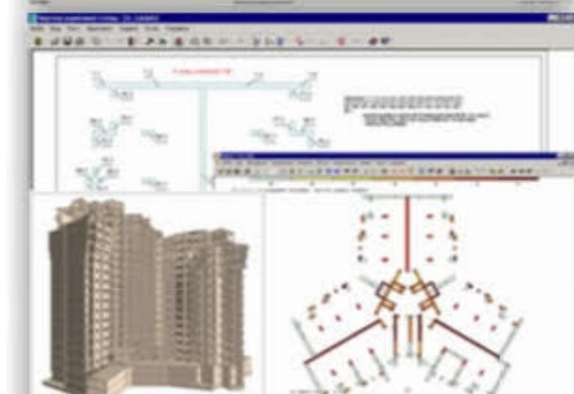
Определяется необходимая площадь сечения арматуры. Стена конструируется сетками и стержнями. Выполняется чертеж, создается dxf-файл чертежа.
