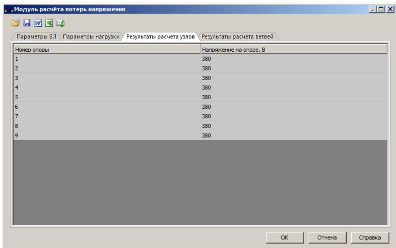
Вкладка "Результаты расчёта узлов" содержит расчетное напряжение на каждой опоре, данные должны совпадать с таблицей расчетов ветвей.
