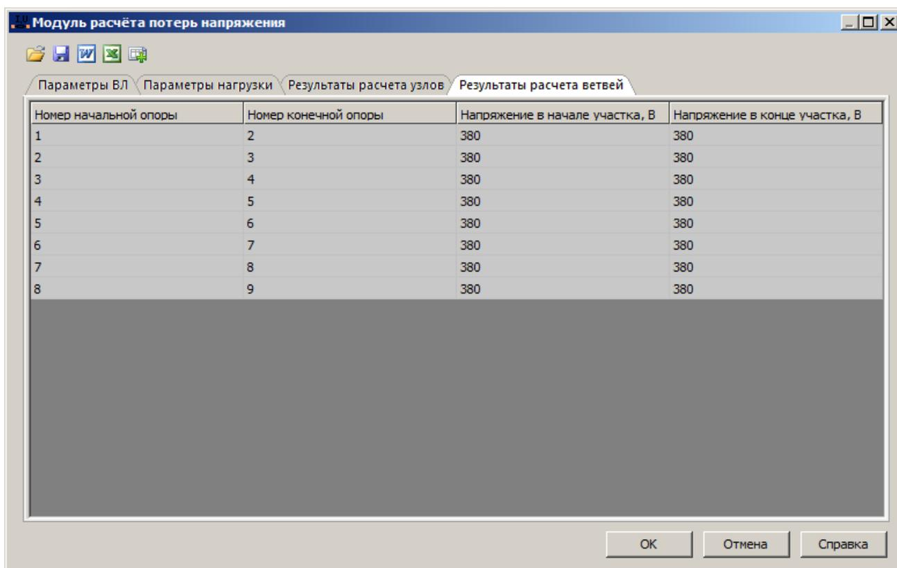
Вкладка "Результаты расчёта ветвей" содержит расчетные данные напряжения и токов. Каждая строка несет себе данные об одном пролете, номера опор, напряжение на концах участка и ток в пролете. Данные по напряжению должны совпадать с таблицей расчёта узлов.
