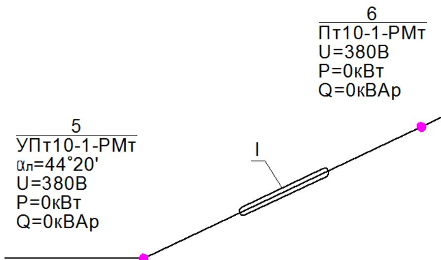
Чтобы добавить пересечение в пролет (пересечение с двумя и более объектами), необходимо снова нажать на кнопку размещения пересечения и указать точку на ВЛ. Если на данном пролете пересечение уже имелось, то пересечения объединятся. Количество пересекаемых объектов на одном пролете неограниченно (пересечение с водоемом должно быть единственным в пролете).
