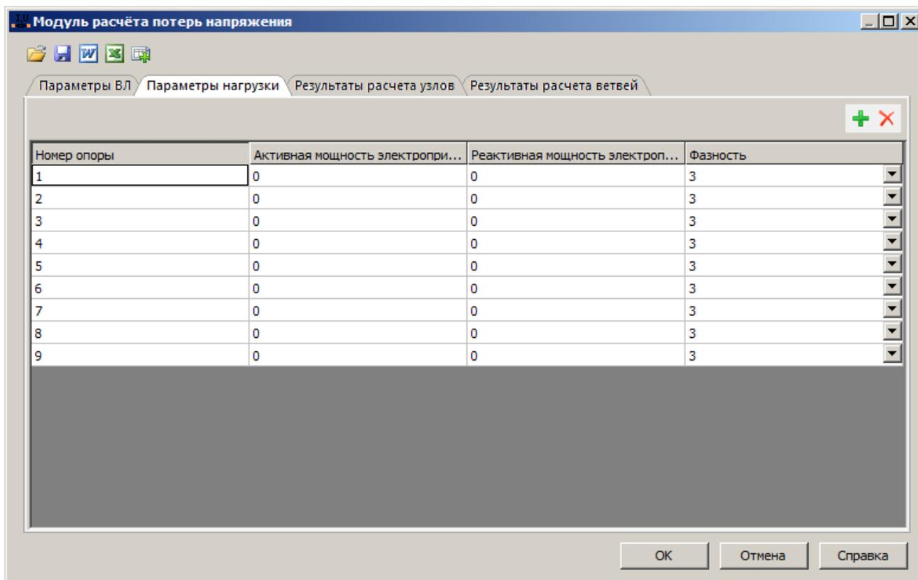
Вкладка "Параметры нагрузки" содержит данные по мощности электроприемников на опорах. При необходимости исходные данные дополняются вручную.
