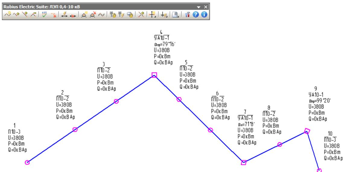
Библиотека позволяет расставить опоры на участке воздушной линии, т.е. выбирать концы линии необязательно.
